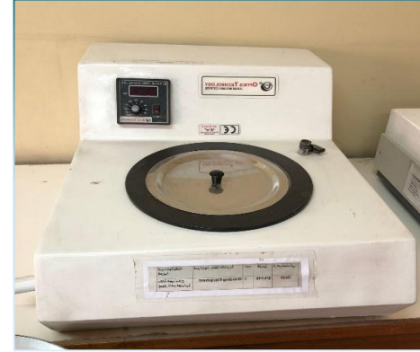
جهاز تنعيم كهربائي ( Grinding Equipment )
