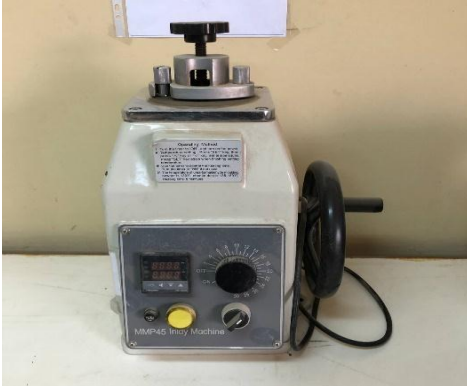
جهاز كبس حراري ( Pressing Machine MMP 45 )
